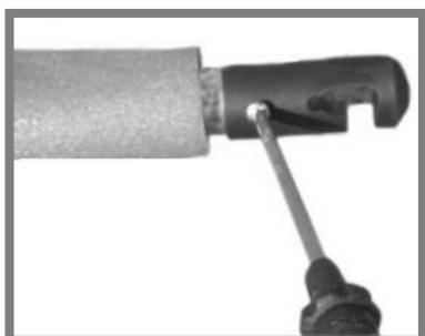
7. Наденьте наконечник на верхнюю стойку и прикрепите шурупом при помощи отвертки.
