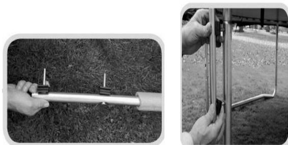
2. Используйте винт, чтобы прикрепить стойку к верхнему отверстию опорной ножки и к верхней трубке основного каркаса. Используйте еще один винт, чтобы прикрепить стойку к нижнему отверстию опорной ножки и к основанию ножки. Используйте гаечный ключ для затяжки гайки на винте.
